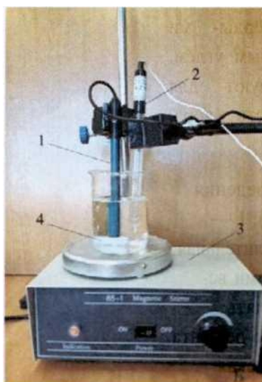
Рис. 2. Установка для определения концентрации (активности) хлорид-ионов в растворе. А: 1 —
